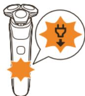
El símbolo "desenchufar para usar" parpadea para recordarle que debe desconectar el dispositivo de la toma de corriente y desconectar la clavija pequeña del dispositivo antes de encenderlo.
