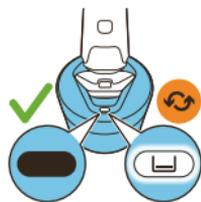
Reemplace el cartucho de Quick Clean Pod en cuanto aparezca el icono de sustitución o con arreglo a la tabla siguiente.
