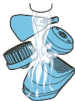
Consejo: Si no es suficiente con enjuagar el recortador para nariz/orejas debajo del grifo, presione el accesorio contra el mango y sumerja el cabezal de corte en un vaso con agua tibia durante unos minutos. A continuación, encienda el dispositivo y enjuáguelo bajo el grifo.
