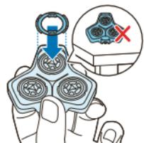
Nota: Aguante el soporte del cabezal de afeitado con la mano cuando vuelva a colocar los cabezales de afeitado y los anillos de retención. No coloque el soporte de los cabezales de afeitado sobre una superficie, ya que podría dañarlos.
