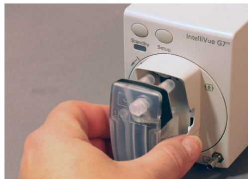
Монтиране на водоуловителя
