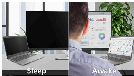
Die PowerSensor 2-Funktion dieses Monitors reduziert den Energieverbrauch, da sie erkennt, wenn sich der Benutzer näher an den Bildschirm bewegt. Nach dem Umschalten der OSD-Einstellung auf "Benutzer" müssen die Einstellungen in Windows 11 angepasst werden, damit diese Funktion ordnungsgemäß funktioniert. Wenn Einstellungen vorgenommen werden, werden der Monitor und der angeschlossene PC/Laptop aktiviert, sobald sich
