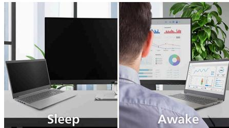
Die PowerSensor 2-Funktion dieses Monitors reduziert den Energieverbrauch, da sie erkennt, wenn sich der Benutzer näher an den Bildschirm bewegt. Nach dem Umschalten der OSD-Einstellung auf "Benutzer" müssen die Einstellungen in Windows 11 angepasst werden, damit diese Funktion ordnungsgemäß funktioniert. Wenn Einstellungen vorgenommen werden, werden der Monitor und der
