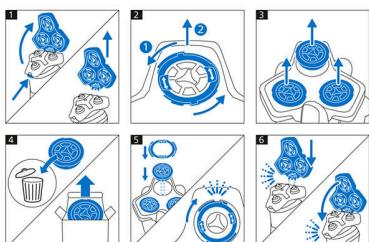
1. Appuyez sur les boutons de déverrouillage et retirez le support des têtes de rasage. 2. Retirez les bagues de fixation en les tournant dans le
